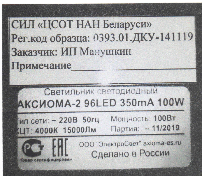
Рисунок 6 – Фотография маркировки и регистрационной этикетки образца светильник светодиодный Аксиома-2 96LED 350mA 100W
